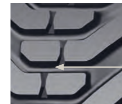
Nokian ELS L-2 tread depth measuring point
