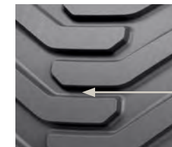
Nokian ELS / Nokian ELS SB tread depth measuring point
