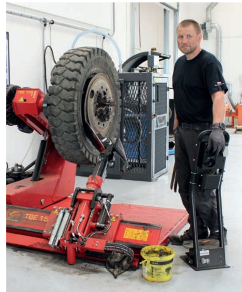
Udstyret til de store dæk er også på plads og Michal Osther Jensen styrer Mondolfo Ferro TBE 156 PRO dækmonteringsmaskinen med kyndig hånd.
